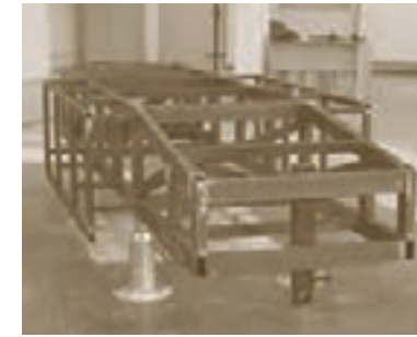
1/4 Stahlrahmen auf Pylonen Steel frame on locating pins
