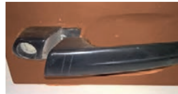
6.3/3 Exterieur-Funktionsmodell eines Türgriffs aus Ureol (auf Glasfaserlaminat) Exterior functional model of a door handle made of Ureol (on glass fibre laminate)
